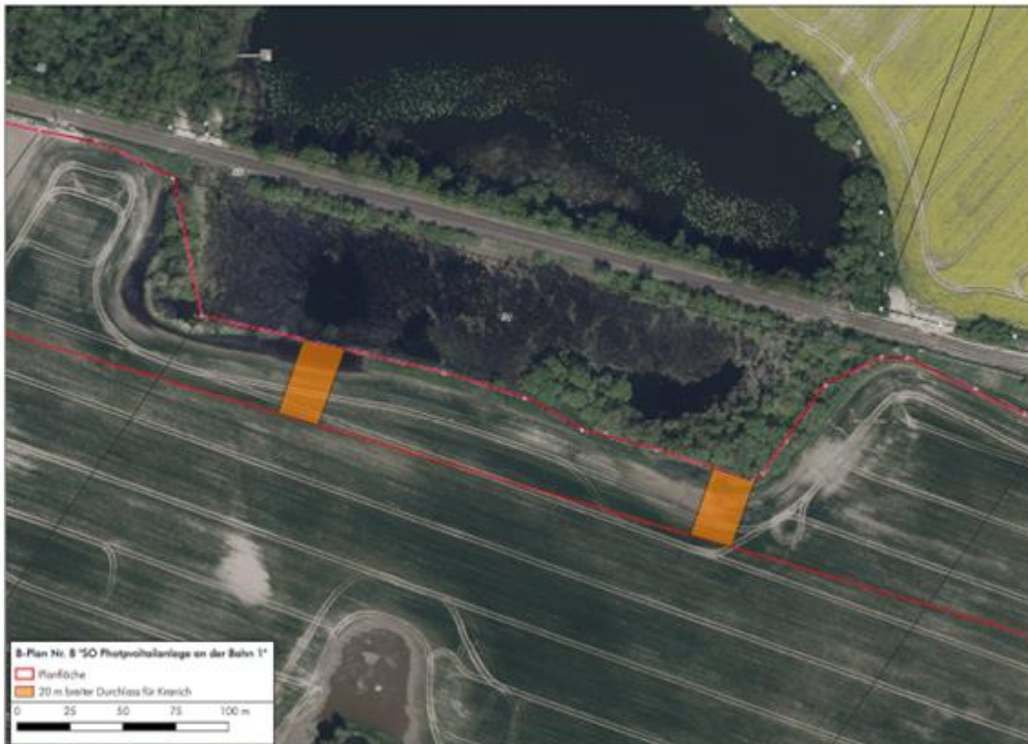
Abbildung 10: Position der zwei 20 m breiten Durchlässe im Bereich des Kleingewässers nördlich des Plangebietes des B.-Plans Nr. 8.
