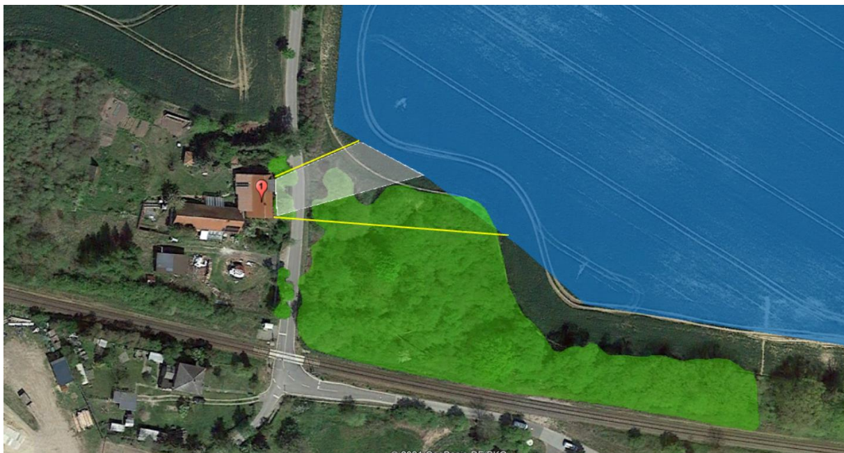
Abbildung 21: Bewuchs (grün dargestellt) als teilweise natürlichen Sichtschutz zwischen PV-Anlage B und OP1. Die gelben Linien stellen die maximal möglichen Winkel der Blendreflexionen ausgehend von der PV-Anlage dar. Die weiße Fläche stellt den Bereich dar, in dem eine Beeinträchtigung der Anwohner durch die PV-Anlage zu erwarten ist
